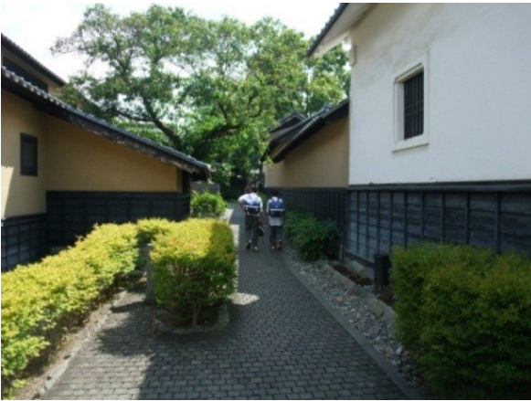
栗の木レンガを敷き並べた小径。古建築の軒高、腰板、開口部の高さを揃えた新築（左）と植栽が景観を整えている。
